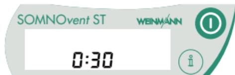
Der Trocknungsvorgang setzt ein: 30 min bei 10 – 12 mbar
